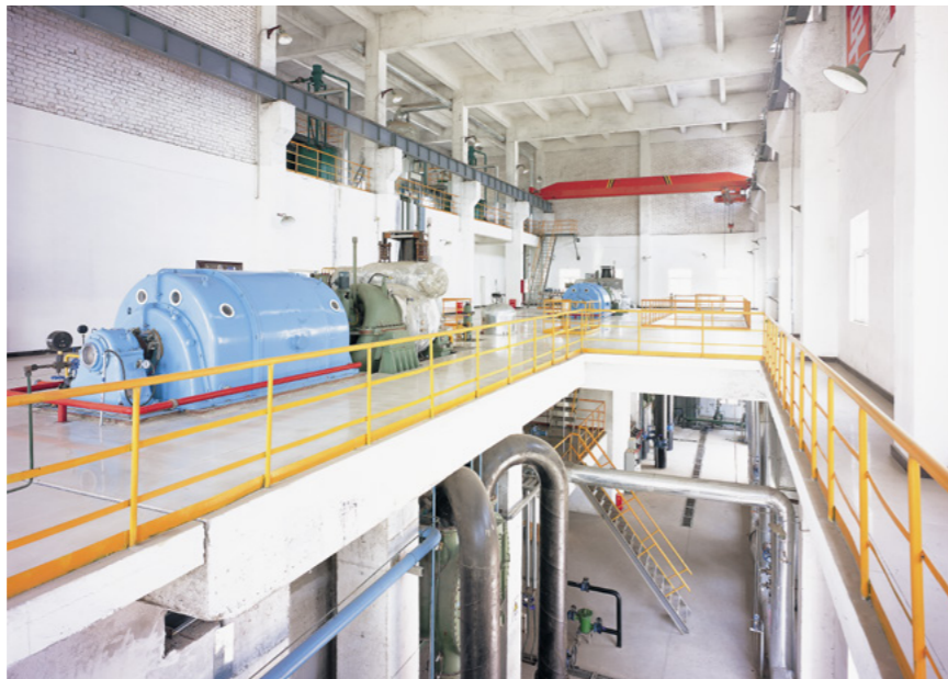
纯低温余热发电机组
